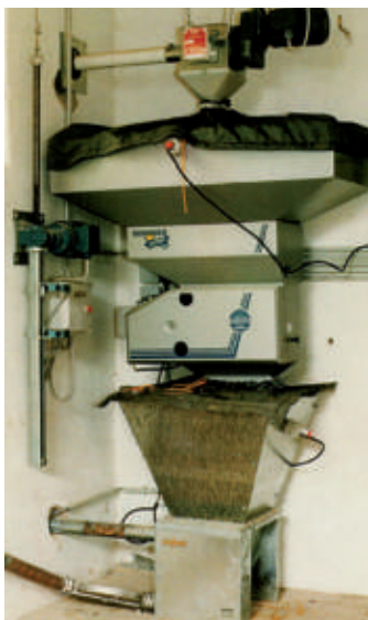
Hafer wird gequetscht und im Futterannahmetrichter mit Pellets vermischt
