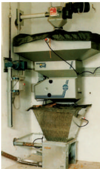
Hafer wird gequetscht und im Futterannahmetrichter mit Pellets vermischt
