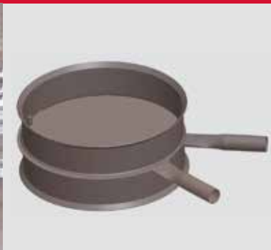
Absperrschieber („Dreh-schieber“) in den Größen D=150 mm bis D=350 mm, aus Edelstahl zum sicheren Verschließen und Öffnen
