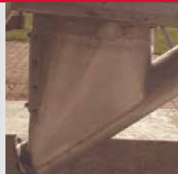
Entnahme mit direkt angeflanschter Förderschnecke
