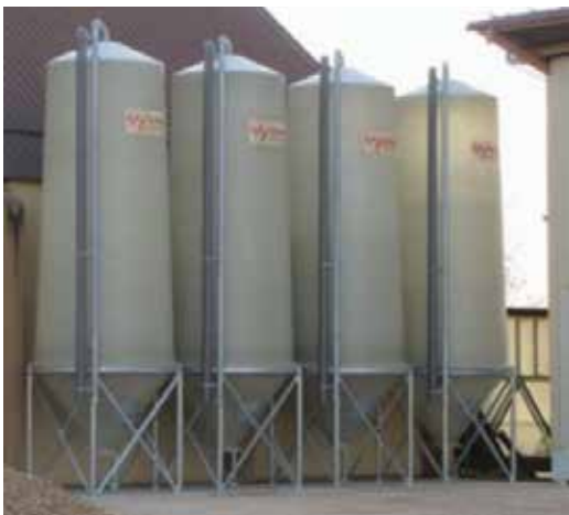
4 x 25 m 3 Silos für Saatgut
